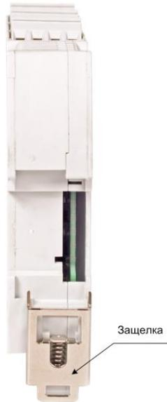
Рис. 4.2. Вид снизу на модуль серии NLS
