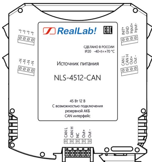
Рис. 1.8 Вид со стороны маркировки на источник питания NLS-4512-CAN
