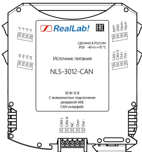
Рис. 1.4 Вид со стороны маркировки на источник питания NLS-3012-CAN
