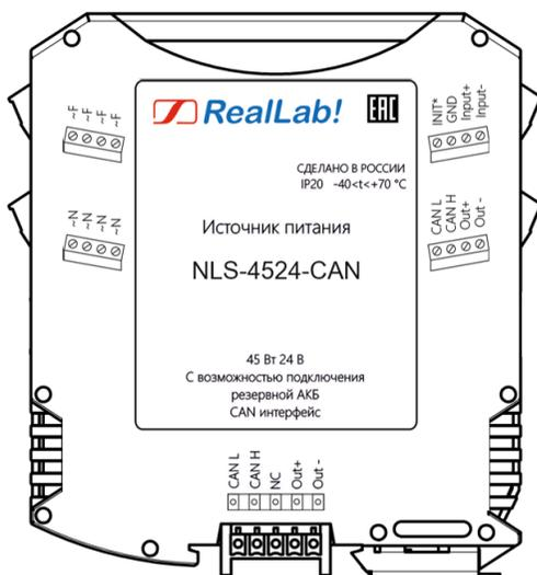
Рис. 1.10 Вид со стороны маркировки на источник питания NLS-4524-CAN
