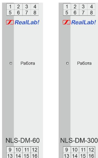
Рис. 4.1. Расположение индикации на лицевых панелях модулей
