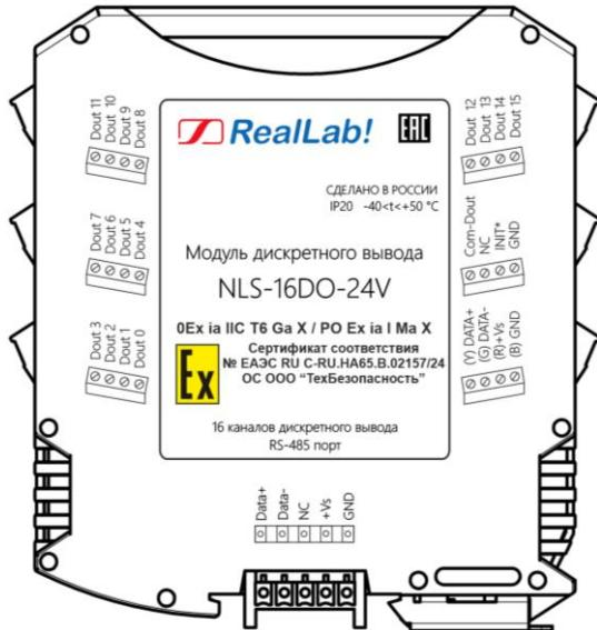
Рис. 2.2. Вид со стороны маркировки на модуль NLS-16DO-24V взрывозащищенного исполнения
