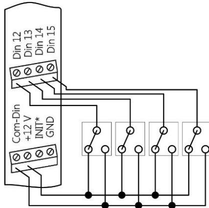
Рис. 5.3. Подсоединение контактов к модулю NLS-16DI-24V с входным каскадом типа «Сухой контакт»
