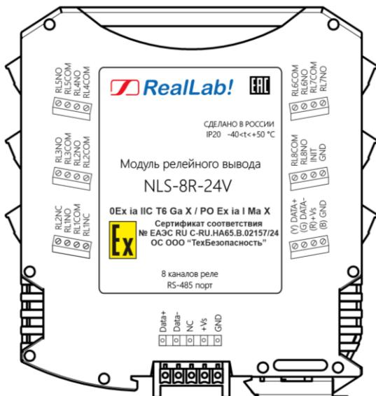
Рис. 2.3. Вид со стороны маркировки на модуль NLS-8R-24V взрывозащищенного исполнения
