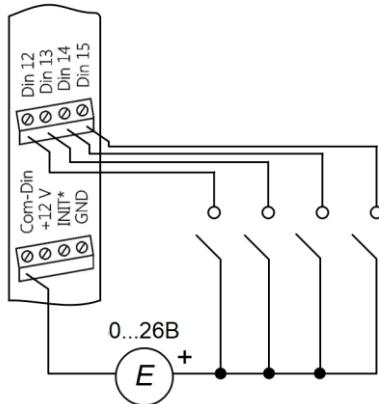
Рис. 5.5. Подсоединение контактов к модулю NLS-16DI-24V с входным каскадом типа «Сухой контакт» с использованием внешнего источника питания
