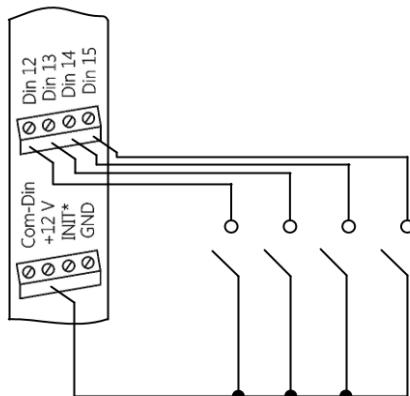
Рис. 5.4. Подсоединение контактов к модулю NLS-16DI-24V с входным каскадом типа «Сухой контакт» с использованием внутреннего источника питания
