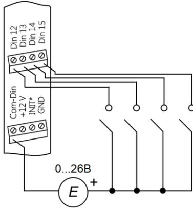
Рис. 5.5. Подсоединение контактов к модулю NLS-16DI-24V с входным каскадом типа «Сухой контакт» с использованием внешнего источника питания
