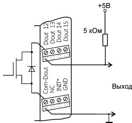
Рис. 5.8. Получение логических уровней напряжения на выходах модуля NLS-16DO-24V
