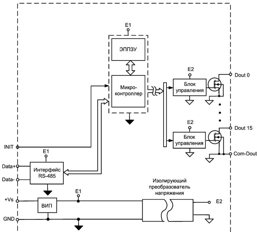
Рис. 4.2. Структурная схема модуля NLS-16DO-24V
