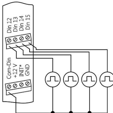
Рис. 5.6. Подсоединение к модулю NLS-16DI-24V источников сигналов с логическими уровнями
