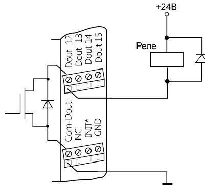
Рис. 5.7. Применение модуля NLS-16DO-24V для управления электромагнитным реле
