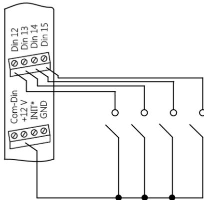
Рис. 5.4. Подсоединение контактов к модулю NLS-16DI-24V с входным каскадом типа «Сухой контакт» с использованием внутреннего источника питания
