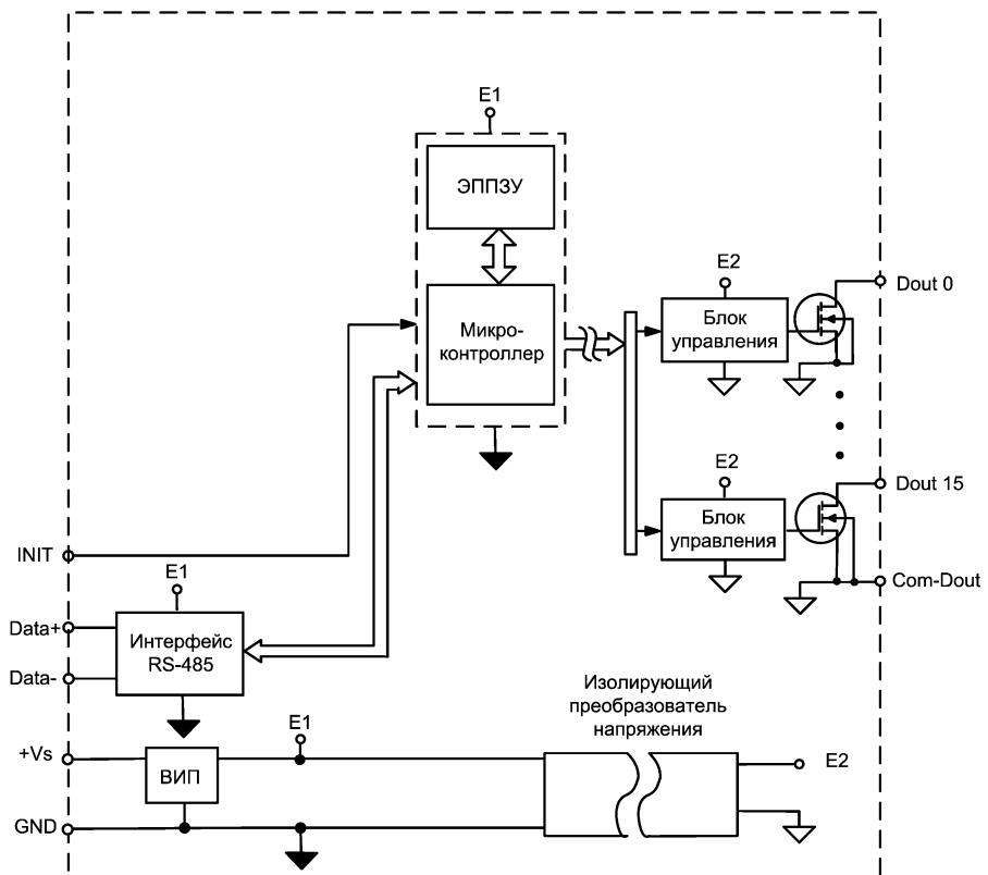
Рис. 4.2. Структурная схема модуля NLS-16DO-24V
