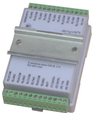
Рис. 4.3. Чтобы закрепить один модуль сверху другого, сначала закрепите DIN-рейку сверху модуля.
