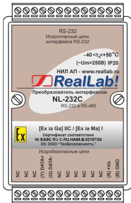
Рис. 1.1. Вид сверху на модуль NL-232C, взрывозащищённого исполнения
