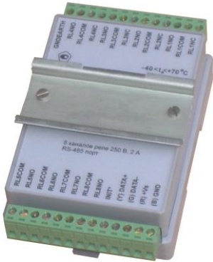
Рис. 4.2. Чтобы закрепить один модуль сверху другого, сначала закрепите DIN-рейку сверху модуля.
