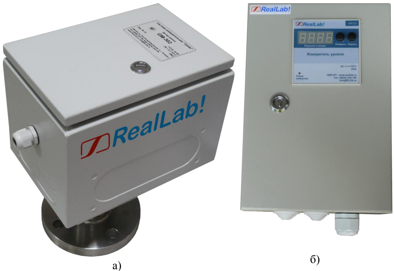
Рис. 2.1. Датчик уровня угольной пыли GM-103: измерительная головка (а) пульт дистанционного управления с индикатором показаний (б)
